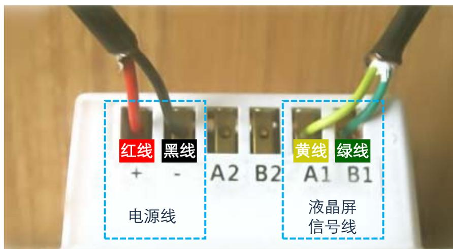
**注：请严格按照示意图标示接线，否则会引起元器件损坏。**
